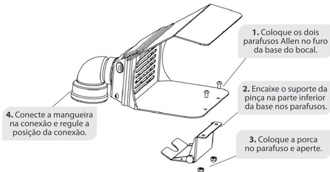
**2° Opção: Fixado na bancada pela pinça o bocal de aspiração na borda da bancada.**
