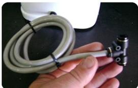
**1º passo** - Conecte a mangueira de entrada de ar na rede pneumática;
